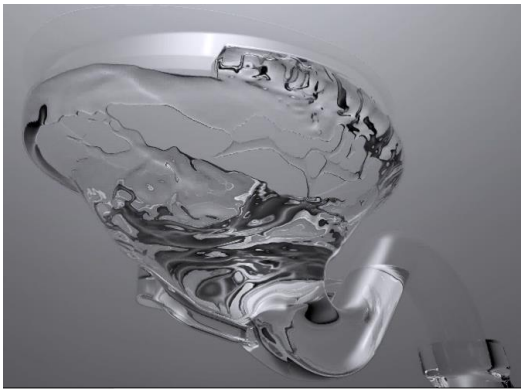
最新のトルネード洗浄のコンピュータシミュレーション 便器表面の薄膜流れまで精度良く再現できる
